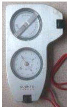
Máy Clinometer: Địa bàn và đo cao, dốc
