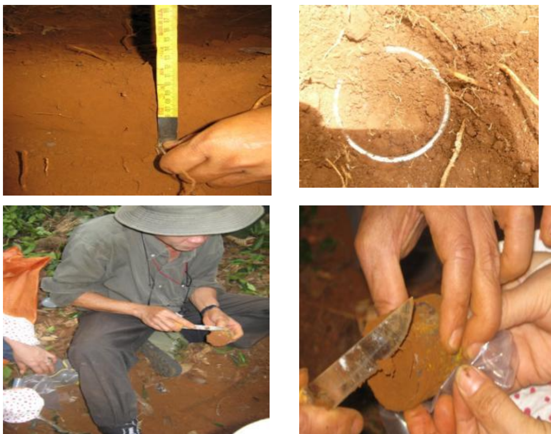
Hình 2.3: Quá trình xác định dung trọng các tầng đất và lấy mẫu đất nghiên cứu hàm lượng Carbon
