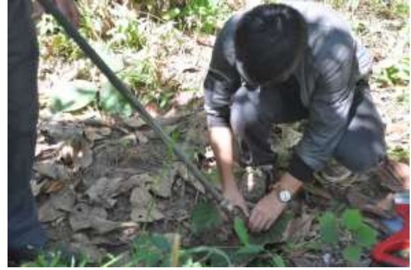
Hình 2.2 Dùng khoan lấy mẫu đất để xác định tỷ lệ % sỏi sạn, đá lẫn có trong đất
