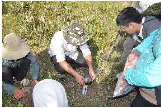
Hình 3.12 Khoan xác định độ dày, lấy mẫu và đo pH đất
