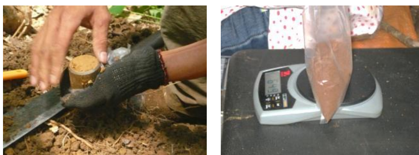
Ống dung trọng đất có thể tích V=50cm^3 Cân điện tử cân khối lượng đất với V=50cm^3
