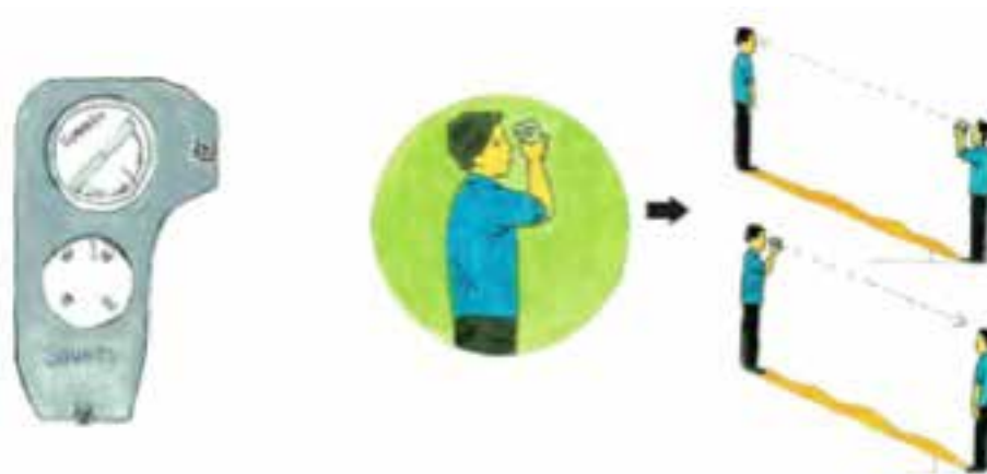
Hình 3: Sử dụng Clinometer để đo độ dốc
