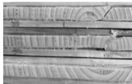
Hình 1. Trái: Thiết bị đọc bề rộng vòng năm; Phải: Mẫu lõi gỗ khoan dưới kính hiển phóng đại 40 lần
