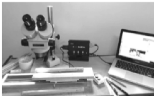
Hình 1. Trái: Thiết bị đọc bề rộng vòng năm; Phải: Mẫu lõi gỗ khoan dưới kính hiển phóng đại 40 lần
