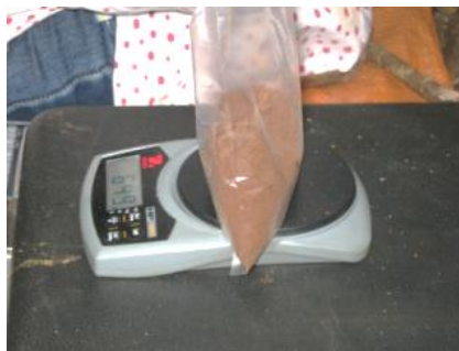
Cân điện tử cân khối lượng đất với V = 50 \text{ cm}^3
