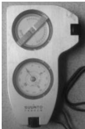
Máy Clinometer có chức năng địa bàn và đo cao, dốc
